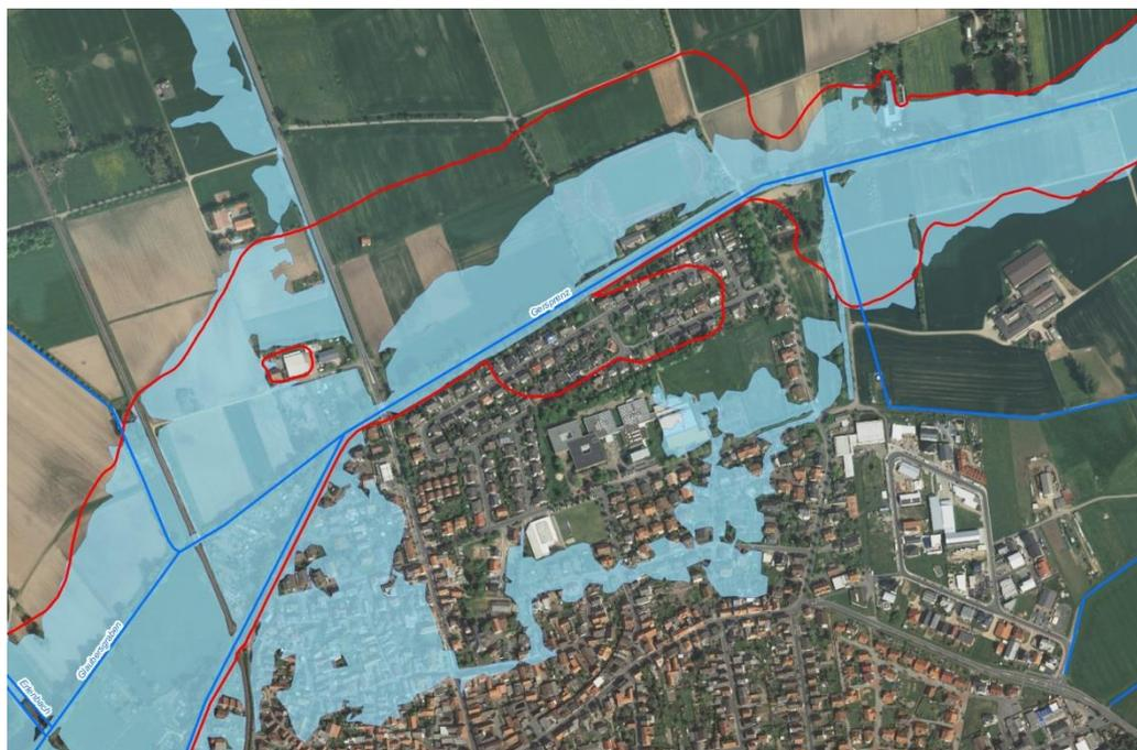
Abbildung 1: Abweichungen zwischen amtlich festgesetzter Überschwemmungslinie (rot) und der Überschwemmungsfläche HQ100 aus HWRMP (blau)
